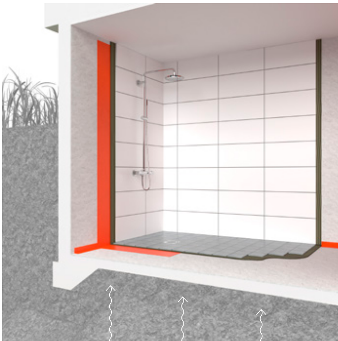
FIGUR 2. Källare med tillskjutande markfukt
