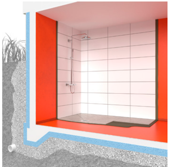
FIGUR 3. Källare utan tillskjutande markfukt
