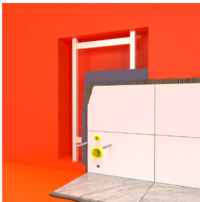
FIGUR 23. Tätskikt bakom inbyggd WC i vägg
